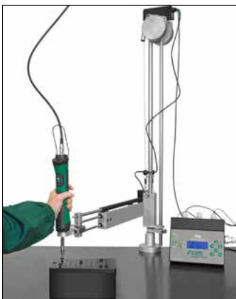
Brazo cartesiano y dispositivo de reconocimiento de la posición
